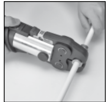
6 Start pressing Pressen Sie das Rohr
