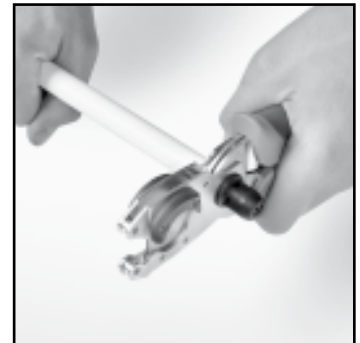
3 Deburr and calibrate Entgraten Sie es und kalibrieren Sie es
